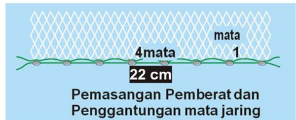
Gambar 2. Pemasangan Tali Ris Bawah
